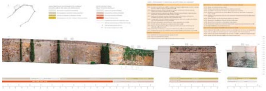
Ejemplos de la utilización de la base fotogramétrica para la especificación detallada de las propuestas de actuación en el campo de la restauración y conservación arquitectónica (campo A). Tramos del Seminario (sector 5) y del Fortín Negro (sector 6).
